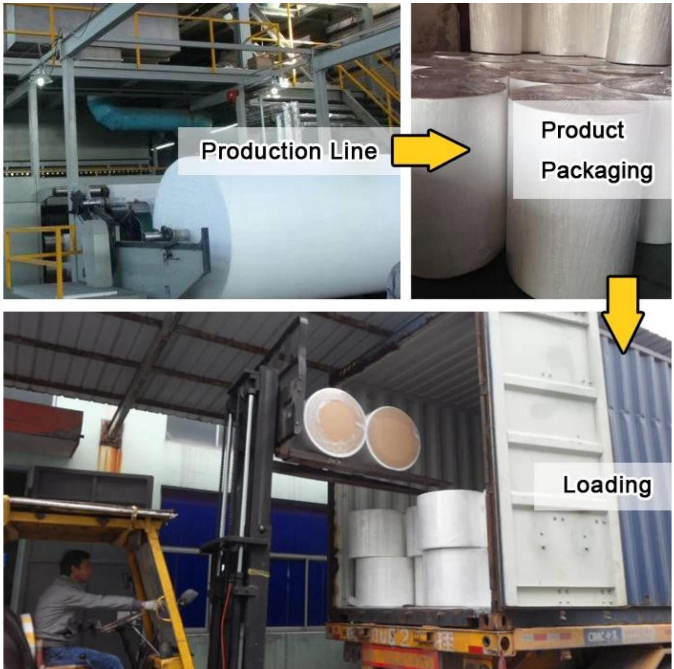
Упаковка продукта и доставка иглопробивного полиэфирного геотекстиля, не сплетенного для дорожного покрытия
